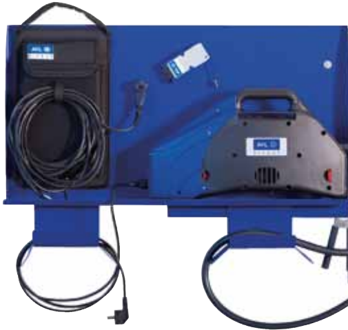
Speziell für die Diesel-AU an Nutzfahrzeugen ist das AU-Gerät MDS 305 konzipiert, das völlig modular aufgebaut ist.
